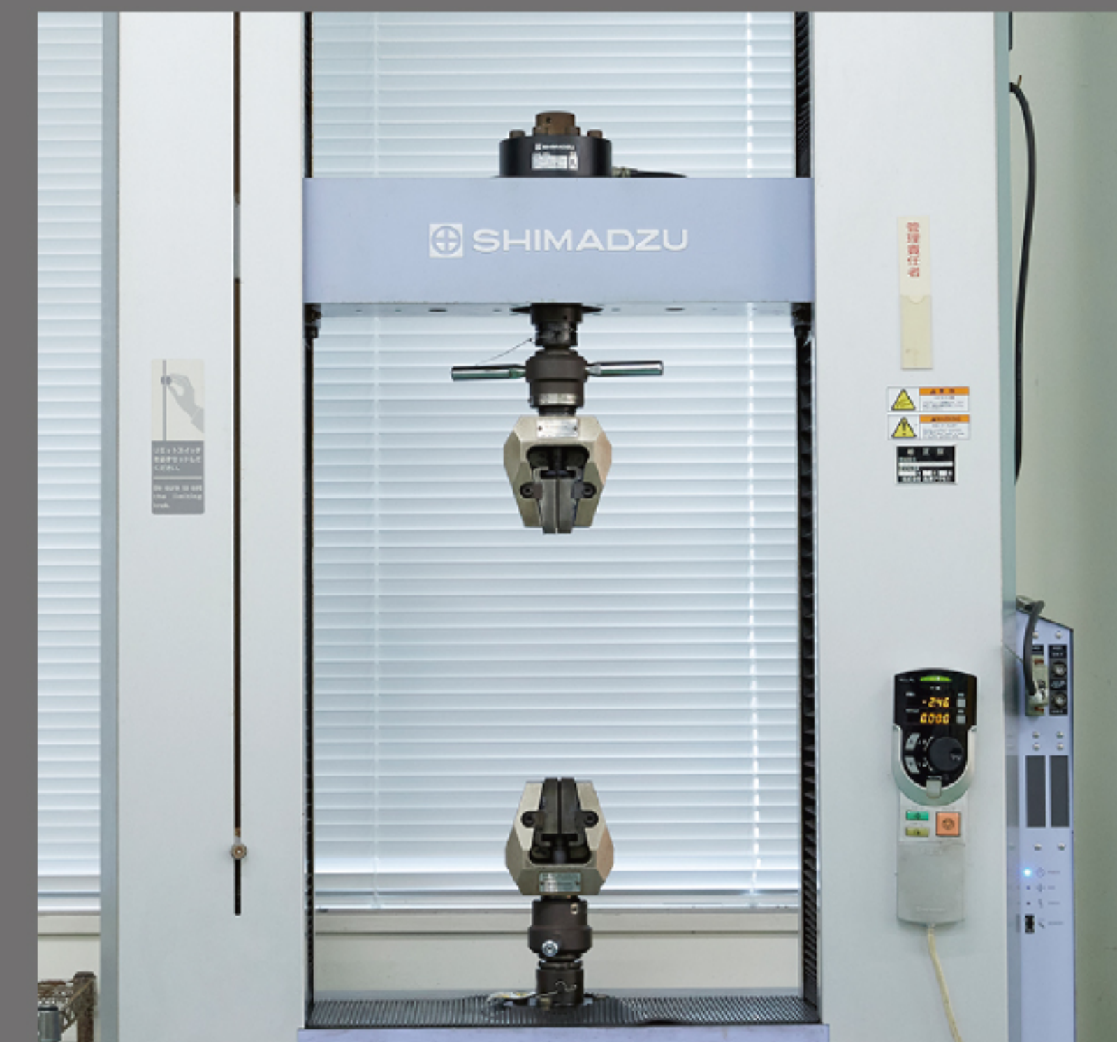
引っ張り試験機 (SHIMADZU_AG-X)
