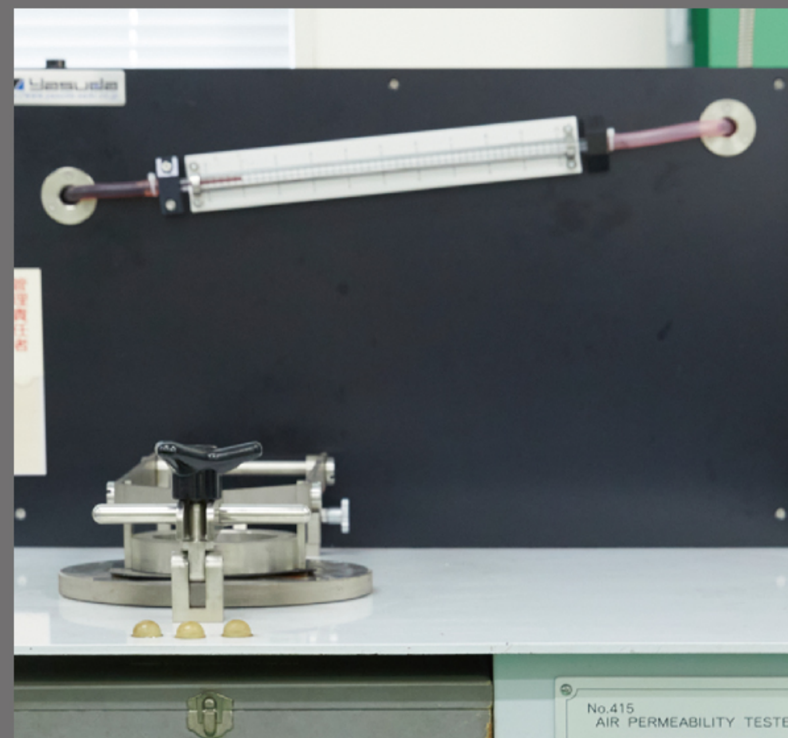
通気度試験機 フラジール型 (yasuda_No415)
